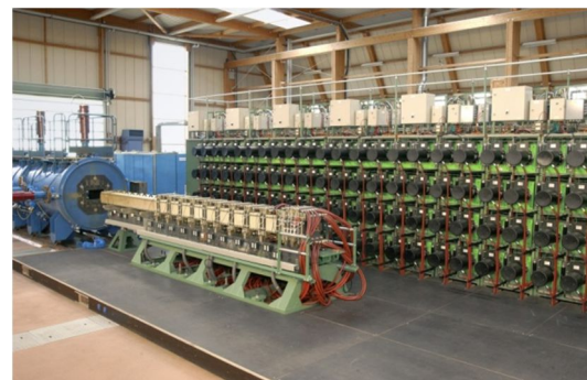
Figure 1 : schéma d'un lanceur électromagnétique à rails et lanceur à rails PEGASUS de 10 MJ.
