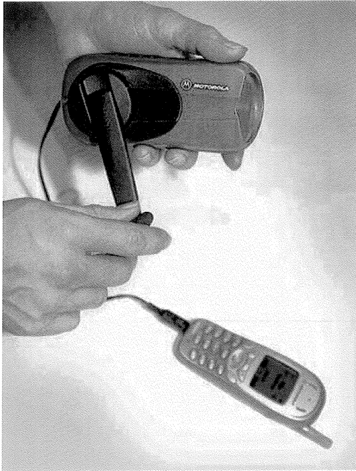
Dispositif "FreeCharge" développé par les sociétés Freeplay Energy et Motorola. Source d'énergie manuelle de recharge des téléphones portables
