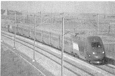
Figure 1 : TGV PBKA (Paris - Bruxelles - Amsterdam - Cologne) quadricourant : (25 kV 50 Hz, 15 kV 16,7 Hz, 1500 V dc et 3000 V dc) ; Puissance : 8800 kW sur LGV
