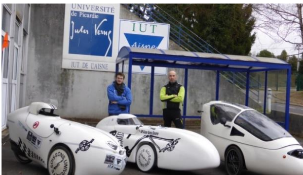
Fig 1. Différentes réalisations de cycles électriques motorisés entièrement carénées (de 50 kg à 85 kg) [8, 9, 10].
