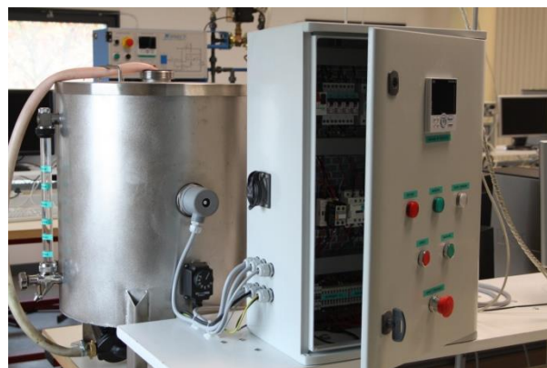
Figure 1 : Photo système de régulation de température
