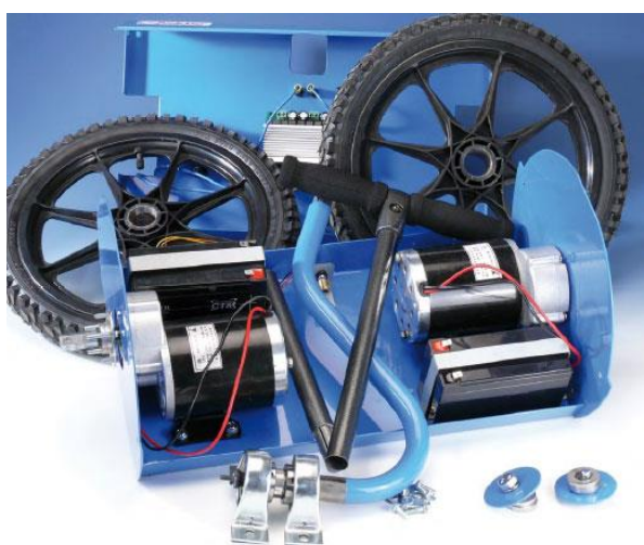
Fig. 6. Le kit ElektorWheelie pour la réalisation d'un gyropode électrique [15].
