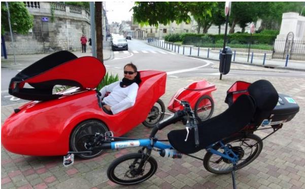
fig 11 : vélo-mobile et vélo-couché électriques pouvant transporter 30 kg de bagages en utilisant des sacs ou une remorque
