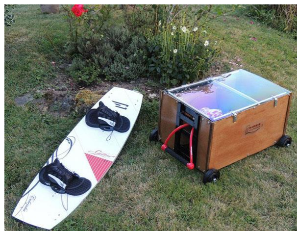
Fig. 5. Le treuil électrique pour la pratique du wake-board sur lac (le pack batterie n'est pas sur la photo). Réalisation Benjamin ROBIN [14].
