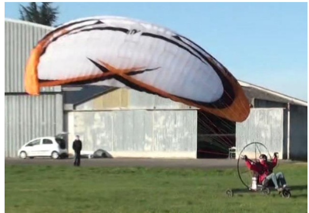
Fig. 4. Propulseur électrique pour parapente développé par Stéphane LELONG [13].
