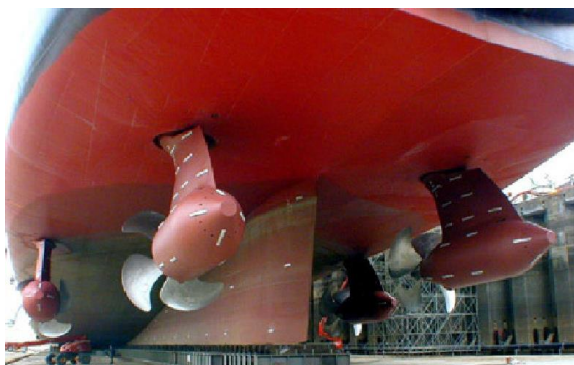
Figure 14 – PODs du Queen Mary 2. Photographie Internet, prise à Saint Nazaire lors de sa construction.
