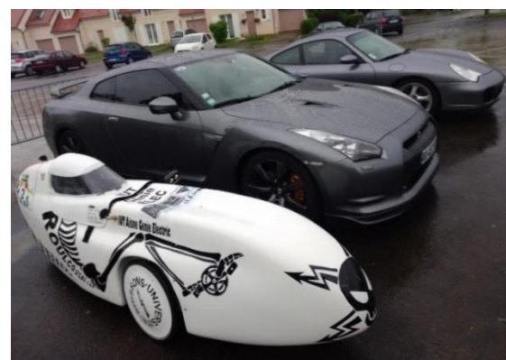
fig 10 : Vélo-mobile électrique monoplace de 50 kg, 3 kW, 250km d'autonomie, 45 km/h de moyenne, à côté d'une
