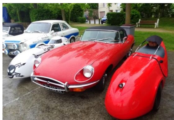
fig 9 : vélo-mobiles qui peuvent rouler sur la route et monter des pentes de 15% avec 20kg de bagages à côté de prototypes de l'éco marathon 2016
