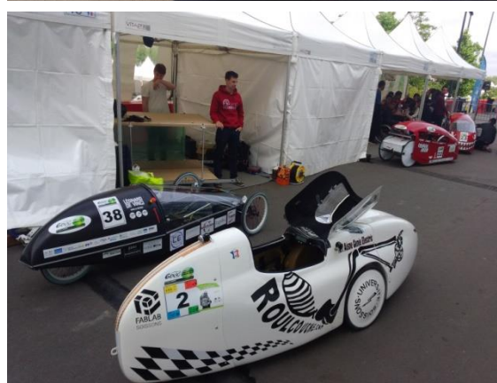
fig 9 : vélo-mobiles qui peuvent rouler sur la route et monter des pentes de 15% avec 20kg de bagages à côté de prototypes de l'éco marathon 2016
