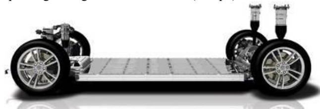
Fig.7 Pack batterie de véhicule TESLA intégré dans le plancher [5]
