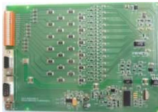
Fig.3 Carte de surveillance et d'équilibrage d'un module de batterie Lithium-ion
