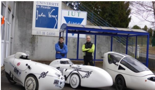
fig 1: Différentes réalisations de cycles électriques motorisés entièrement carénés (de 50 kg à 85 kg) [2, 3]
