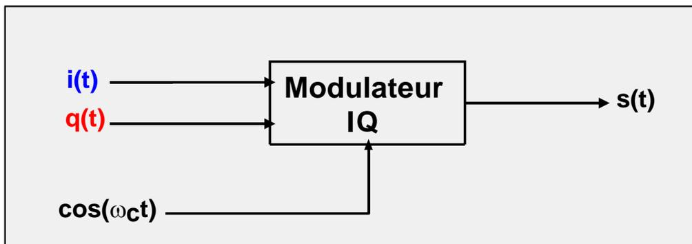
On donne les caractéristiques d'une modulation (type de modulation et diagramme de constellation associé, ainsi que les caractéristiques de l'onde porteuse), et on demande de tracer, à partir de la seule observation du diagramme de constellation  $\mathbf{q(t) = f[i(t)]}$ , l'allure des tensions  $\mathbf{i(t)}$ ,  $\mathbf{q(t)}$  et  $\mathbf{s(t)}$ .
