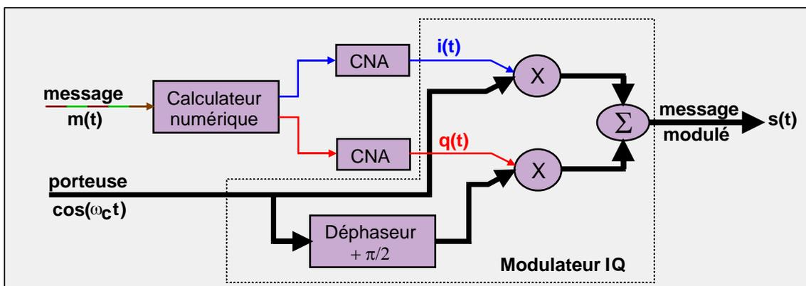
Le modulateur intègre un **calculateur numérique** ainsi que deux **convertisseurs numérique-analogique** permettant d'élaborer, à partir du message numérique  $m(t)$  à transmettre, 2 tensions analogiques internes  $i(t)$  et  $q(t)$ , pour lesquelles l'évolution  $q(t) = f[i(t)]$  peut se représenter sous forme vectorielle (**vecteur de Fresnel**). C'est la raison pour laquelle on utilise souvent le terme générique de **modulation vectorielle** pour désigner toute modulation numérique.
