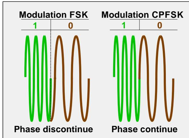
On montre que pour qu'une modulation FSK présente une phase continue (donc soit de type CPFSK), l'excursion de fréquence  $\Delta f$  et la fréquence rythme  $f_r$  doivent être telles que :
