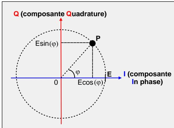
Ainsi, à tout couple de valeurs de paramètres (Amplitude E, Phase  $\varphi$ ) associés à la tension modulée  $s(t)$ , correspond un seul et unique couple de valeurs  $(I, Q)$ , de coordonnées  $(E \cos \varphi, E \sin \varphi)$ .
