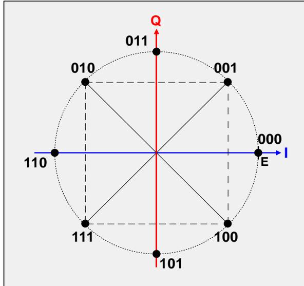
On obtient évidemment, dans ce cas, pour une vitesse de modulation de  $f_r$  **symboles/s**, une vitesse de transmission de  **$3f_r$  bits/s**.
