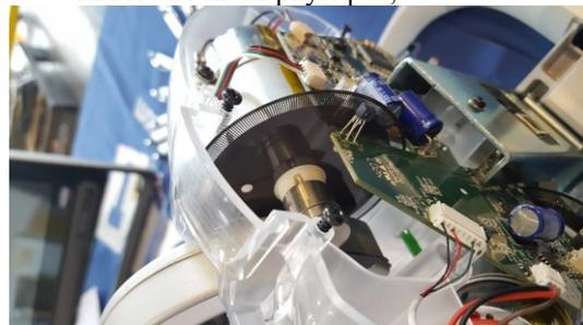
Figure 3: vue interne du codeur incrémental sur le robot haptique
