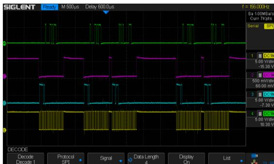
Figure 6: trames d'un capteur de température par un bus SPI
