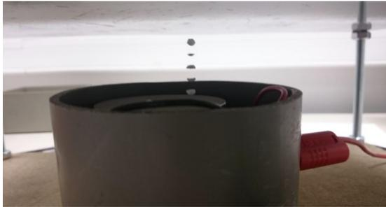
**Figure 4 : Observation de la lévitation de billes de polystyrène**
