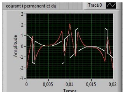
2 Tension aux bornes de Z_L \Delta u et le courant de ligne i_L
