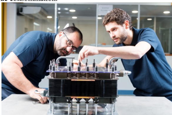
© Safran Power Units – Philippe Stroppa Stack : Coeur de pile à combustible
