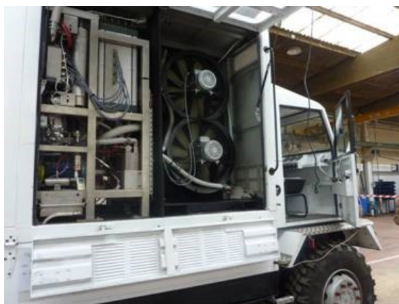
Figure 2 : Vue du système PAC installé sur ECCE
