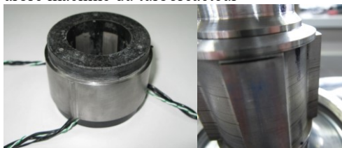
Figure 2 : Gauche: Stator bobiné et enrobé - Droite : rotor monté sur l'arbre turbomachine
