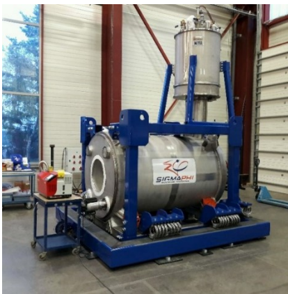
Figure 4 : Quadropôle supraconducteur pour JLAB
