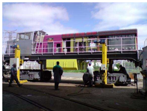
Figure 5 : Mise sur bogies du locotracteur hybride SNCF dans sa version hydrogène.
