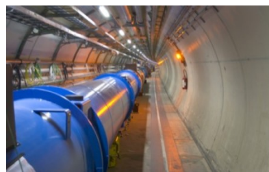
Figure 2.: aimants supraconducteurs (8,4 T) du LHC.
