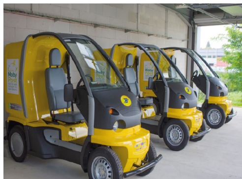
Figure 1 : Véhicules Mobypost– Première flotte de véhicules à hydrogène déployée en France (Chaîne de traction intégrée @ FCLAB / FEMTO-ST / UTBM)
