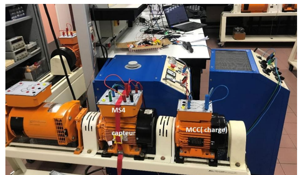
Figure 19. Machine synchrone expérimentale saine MS4 de 1,2KW.
