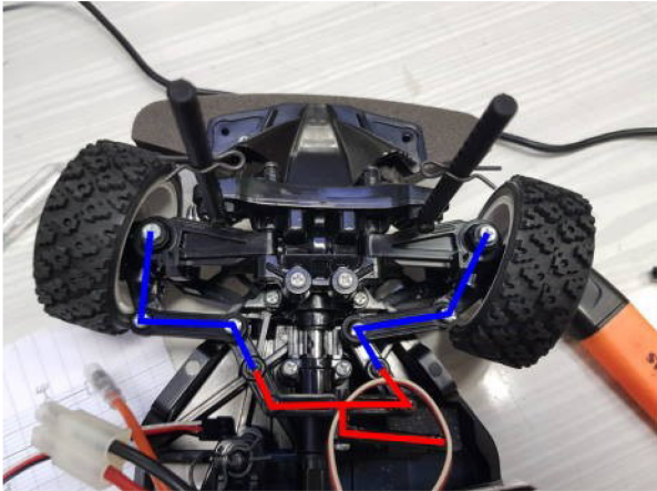
Figure 4 : Détail du système de biellettes de commande de direction
