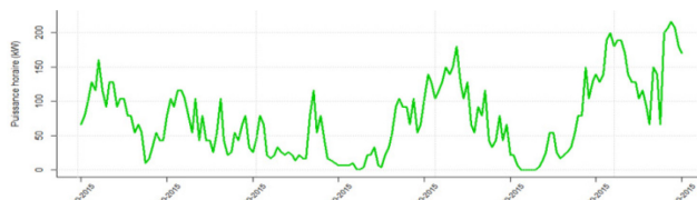
Figure 17 : Exemple de production horaire de l'éolienne de 250 kW sur une semaine d'octobre
