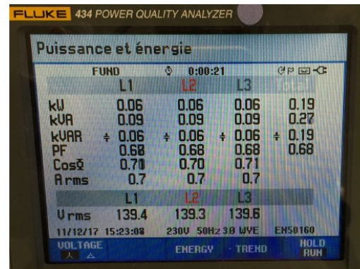
(b) Flux de puissance réactive de la GADA vers le réseau.
