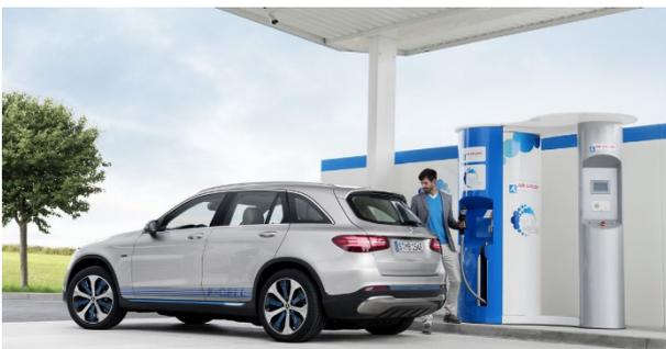
Figure 23 : Véhicule Léger Mercedes GLC F-Cell : hybridation intermédiaire (mild-hybrid) avec une PàC d'une cinquantaine de  $kW$ .
