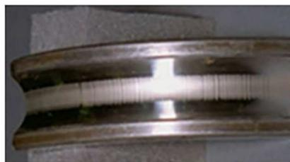
Figure 5 : Cannelure des roulements sous l'effet des courants de mode commun [6]
