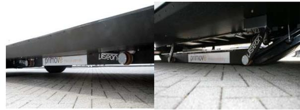
Figure 2 : Secondaire du système Primove développé par Bombardier : a) secondaire pendant le déplacement, b) secondaire abaissé lors de la recharge
