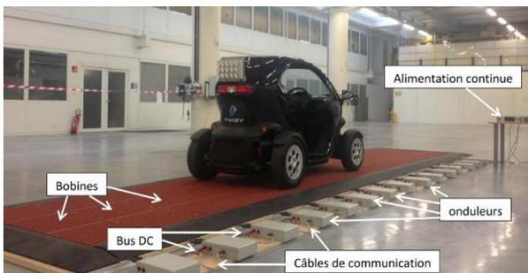
Figure 8 : Système DWPT développé par Renault-Supélec [5]
