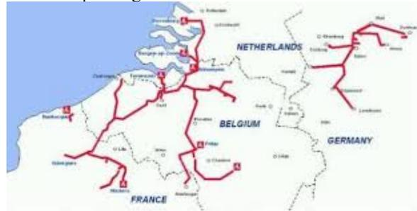
Figure 30: Pipelines dihydrogène possédés et exploités par Air liquide autour des Pays Bas [87]
