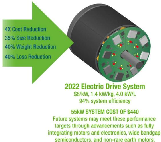
Figure 2 : Chaîne de conversion intégrée [1]
