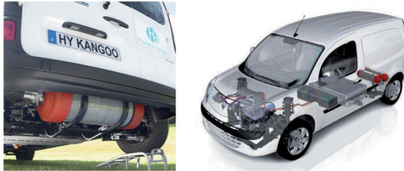
Figure 22 : Véhicule Utilitaire Léger Renault Kangoo ZE H2 de type « prolongateur d'autonomie » [26]
