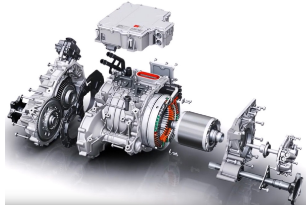
Figure 20 : Groupe motopropulseur Audi APA250 [29]
