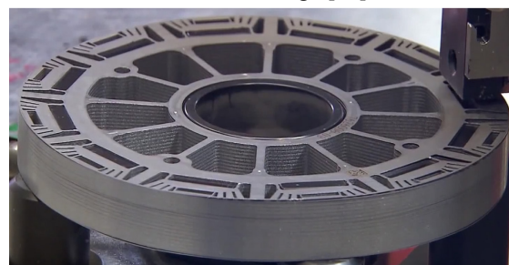
Figure 10 : Rotor du moteur de la BMW i3 en cours d'assemblage [17]
