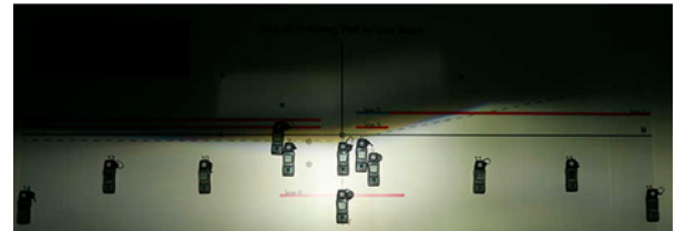
Figure 4. Test d'un éclairage voiture pour vérifier tous les points ECER112 avec des luxemètres à 3.5 m [6]
