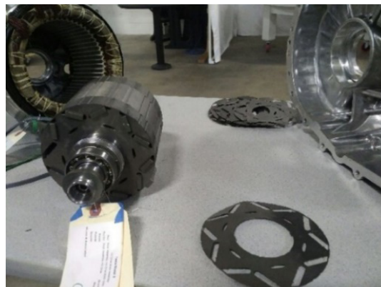
Figure 9 : Moteur à aimants de la Tesla model 3 [15]
