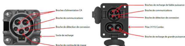
Figure 19 : socle de recharge J1772 et J1772 « Combo » [13]
