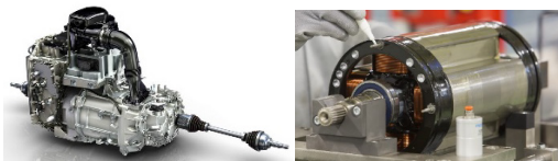
Figure 31 : Groupe motopropulseur Renault 5A Gen3 [37] et rotor bobiné 4 pôles
