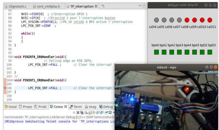
Figure 2 : écran du PC (partiel) : à gauche une partie de l'environnement de développement NXP, à droite la vue caméra sur la carte microcontrôleur NXP et l'interface Python homme/machine de contrôle
