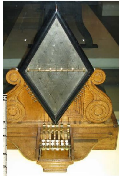
Figure 8 : Cooke et Wheatstone ont utilisé l'effet électromagnétique pour déplacer des aiguilles dans leur dispositif télégraphique. Celui-ci a cinq aiguilles, qui peuvent pointer vers n'importe quelle lettre de l'alphabet. Crédit: Wikicommons
