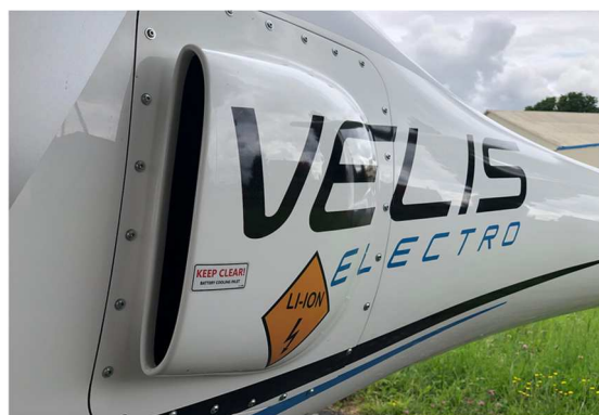
Figure 6 : Une des écopés latérales pour refroidir les radiateurs des batteries
