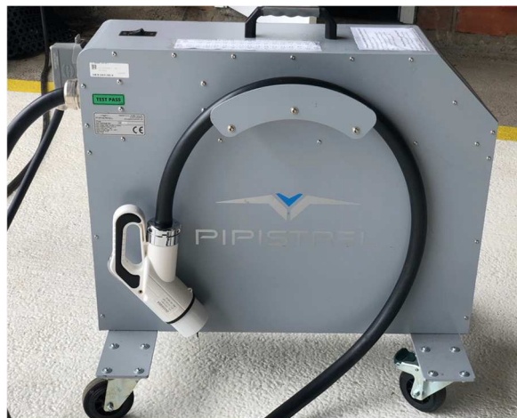
Figure 4 : Le chargeur du Velis Electro
