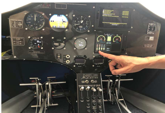
Figure 8 : tableau de bord du Velis, le doigt pointe l'affichage de l'état batterie et chargeur
