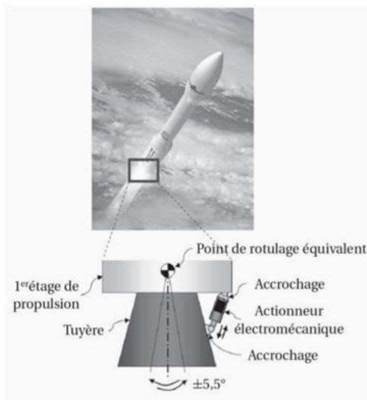
Figure 3 : Actionneur électromécanique d'orientation de la poussée vectorielle du premier étage de propulsion du lanceur européen VEGA.
