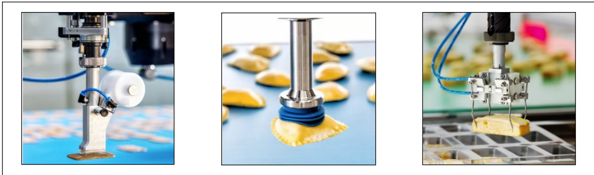
Figure 8 - Différentes pinces et ventouses de préhension des biscuits
