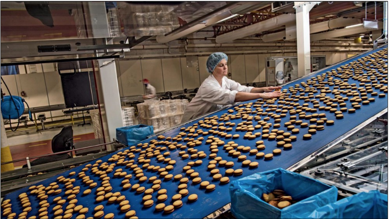
Figure 3 - Sortie de la chaîne de refroidissement des biscuits
