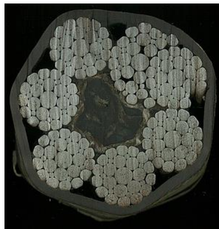
Figure 42 : Vue en coupe d'un nœud d'épissure, source [15]
