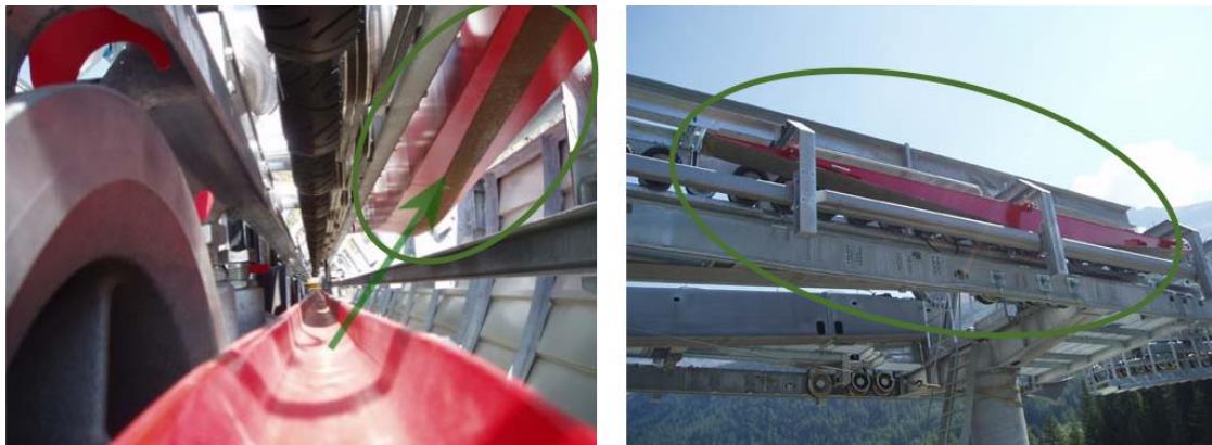
Figure 20 : Rail de débrayage appuyant sur le levier de la pince, source [1]
