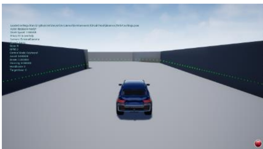
Figure 3 : Véhicule simulé et représentation des points détectés par le capteur LIDAR installé
