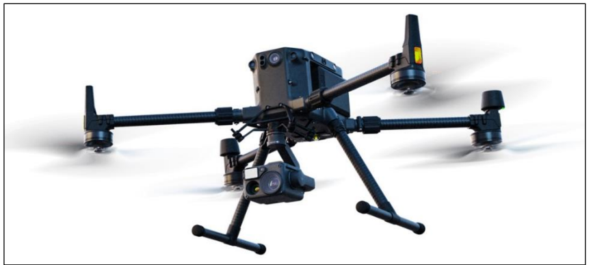
Figure 1 - Drone DJI Matrice 300 RTK équipé de la caméra Zenmuse H20T
