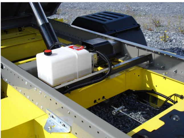
Benne basculante à profil ouvert uniquement vissé, perforé pour s'adapter à plusieurs véhicules
