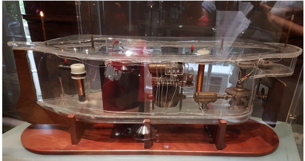
Figure 16 : Le téléautomaton en 1898, et les éléments le constituant présenté au Musée Nikola Tesla (Belgrade), sources [21] [22]
