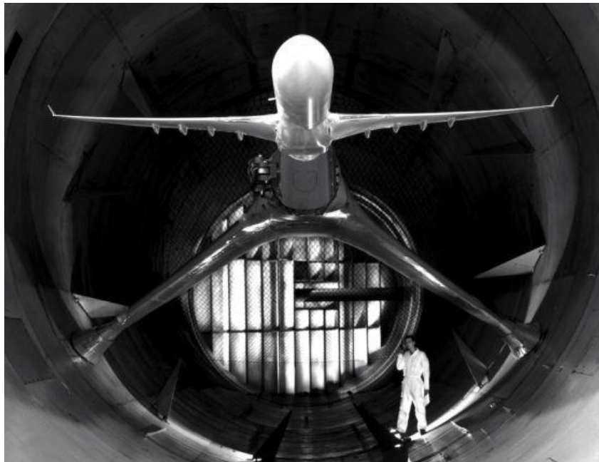
Figure 1 : Soufflerie sonique S1MA à Modane-Avrieux, veine de 14 m de long et 8 m de diamètre, utilisée pour des mesures d'efforts sur une maquette, source ONERA [1]
