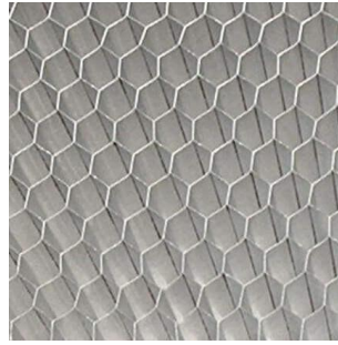
Nid d'abeille aluminium hexagonal par collage-déploiement (Corex™)
