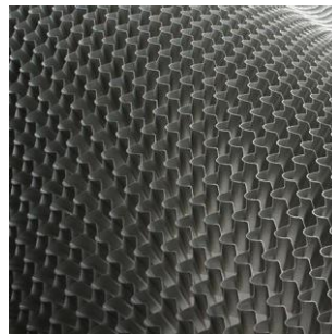
Nid d'abeille aluminium flexcore (R) obtenue par pliage-soudage (Hexcel™)
