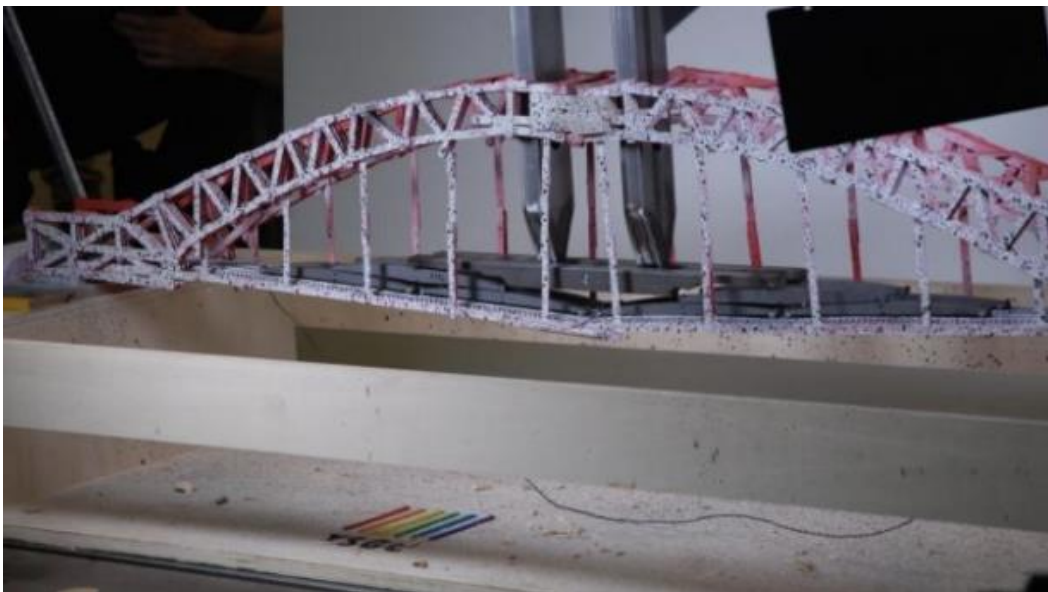
Figure 4 : Système de sollicitation avec les fourches de chargement en action
