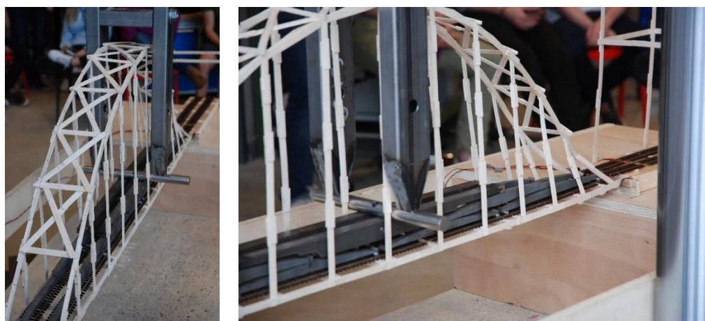
Figure 16 : Flambement du Pont de l'Ascension lors de l'essai
