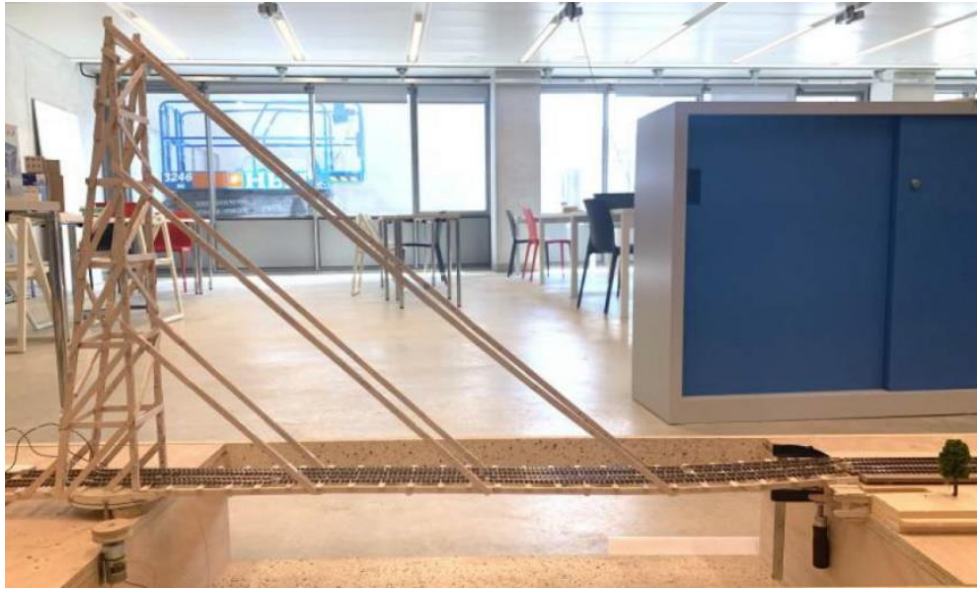
Figure 8 : Maquette définitive de Ponta Cana et ses haubans en bâtonnets
