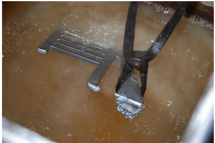
Démoulage et refroidissement de la pièce pour la rendre manipulable
