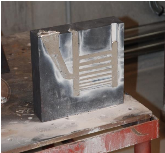
Démoulage et refroidissement de la pièce pour la rendre manipulable
