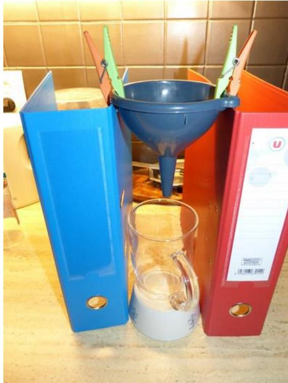
Figure 3 : Dispositif pour estimer la viscosité d'un fluide
