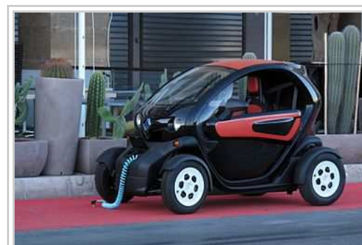
Mode 1 : un Renault Twizy et sa prise de recharge intégrée
