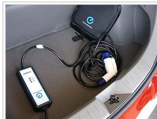
Mode 2 : le câble de recharge sur prise domestique d'une Nissan Leaf
