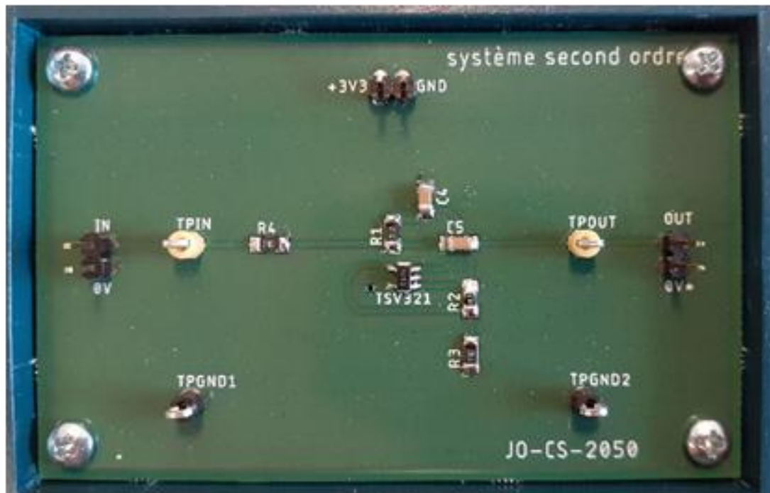
Figure 3 : Carte simulant un système du second ordre à partir d'un TSV321
