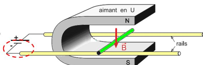
3) Faites l'analogie avec la déviation observée de l'arc électrique lors du soudage à électrode enrobée.
