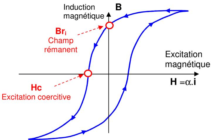
Le champ magnétique rémanent  $B_r$  est le champ magnétique qui subsiste après arrêt de circulation de l'intensité électrique  $i$ .
