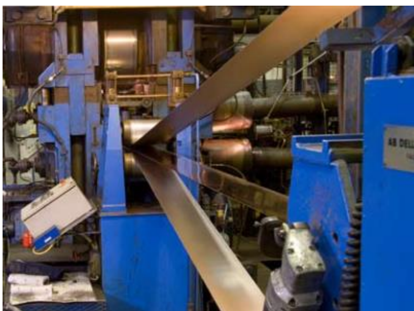
Figure 18 : Co-laminage à la société Kanthal, source [10]
