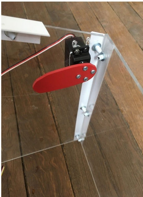
Fixation de la came sur le servo moteur.
