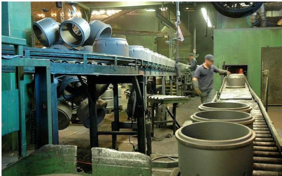
Figure 11 : Recyclage des piles alcalines en tambours de frein, source [18]
