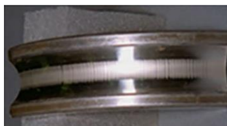
Figure 5 : Cannelure des roulements sous l'effet des courants de mode commun, source [6]
