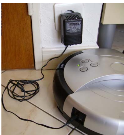
Connexion filaire au transformateur
