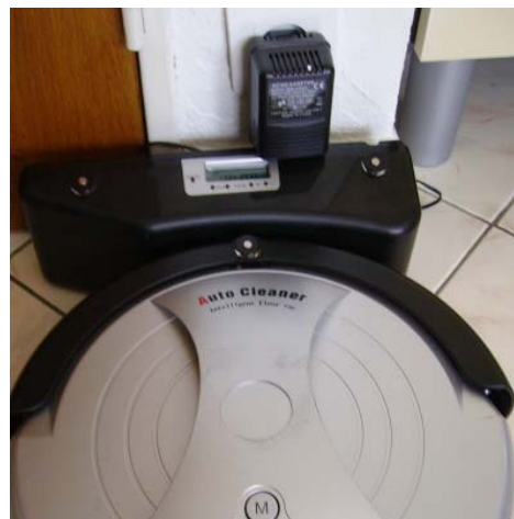
Connexion par les électrodes à la base
