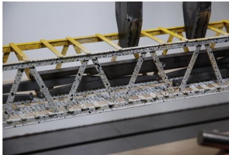
Figure 2 : Mouchetis de peinture nécessaire à la corrélation d'images numériques
