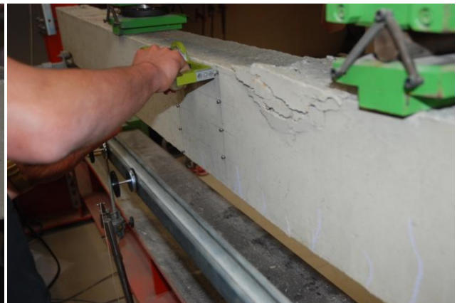
Figure 13 : Endommagement du béton par compression sur la partie supérieure de la poutre
