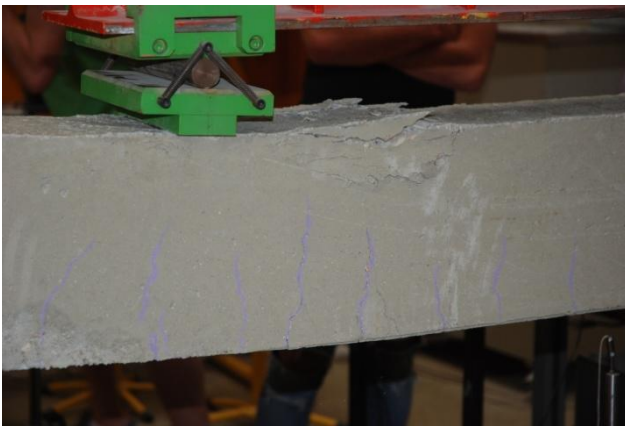
Figure 13 : Endommagement du béton par compression sur la partie supérieure de la poutre
