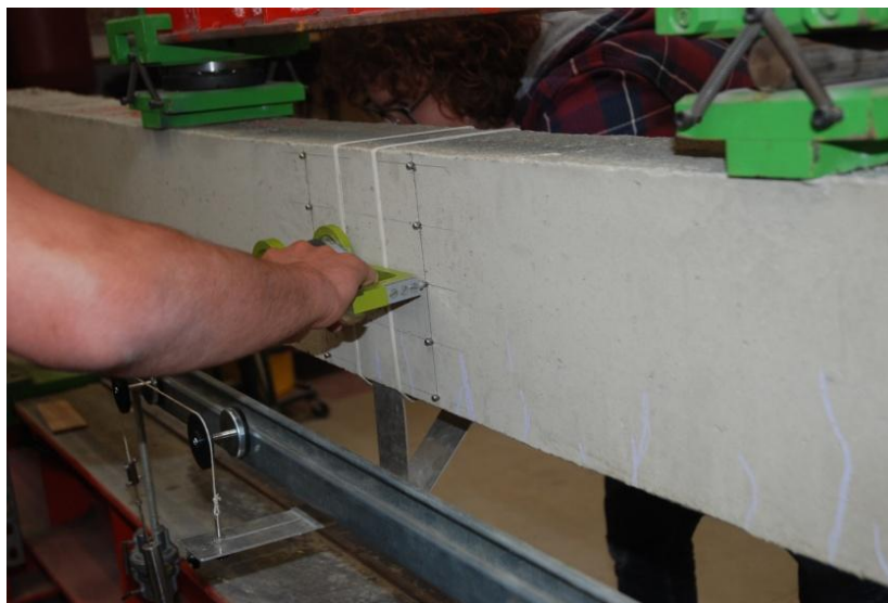
Figure 10 : Mesures des déformations et examen des fissures
