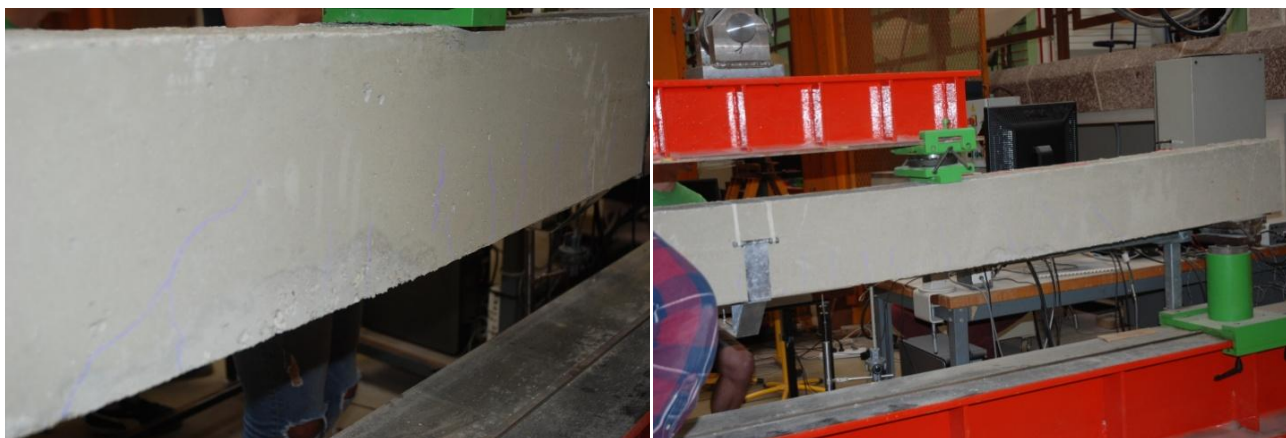
Figure 11 : Apparition de fissures à 45^\circ au-delà des appuis du profilé, flèche de la poutre chargée
