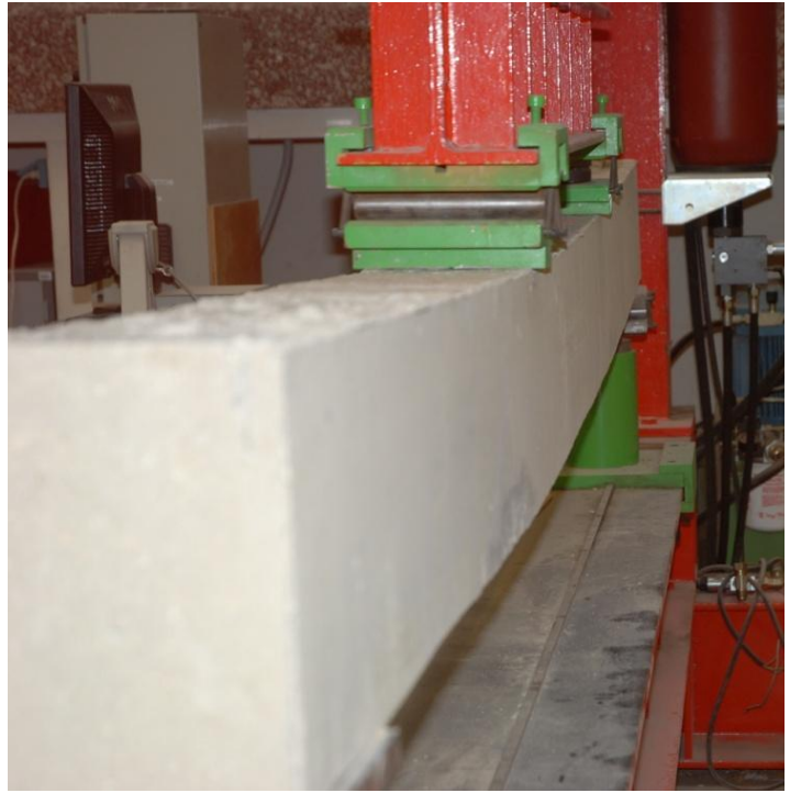
Figure 12 : Agrandissement des fissures et Accentuation de la flèche au cours du chargement
