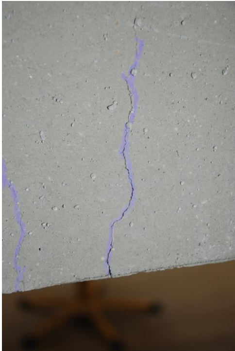
Figure 12 : Agrandissement des fissures et Accentuation de la flèche au cours du chargement
