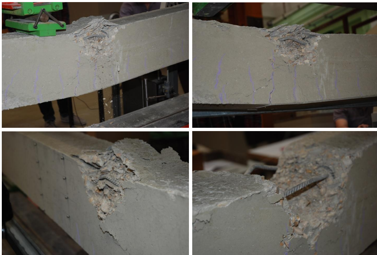
Figure 15 : Flambement des armatures supérieures
