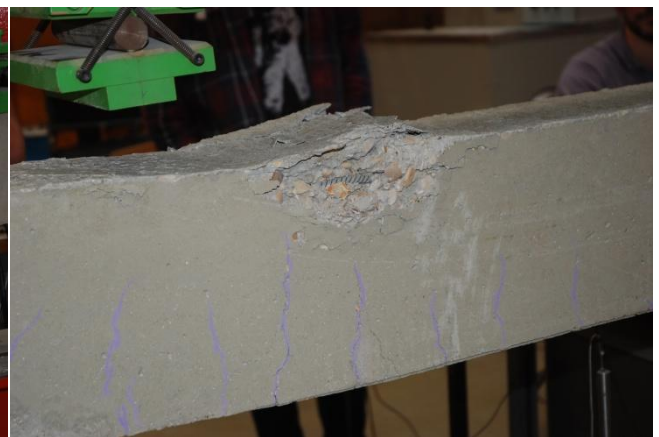
Figure 14 : Déformation permanente de la poutre
