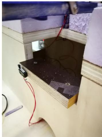
FIGURE 23 – Appuis réalisés sur la rive pour le tablier
