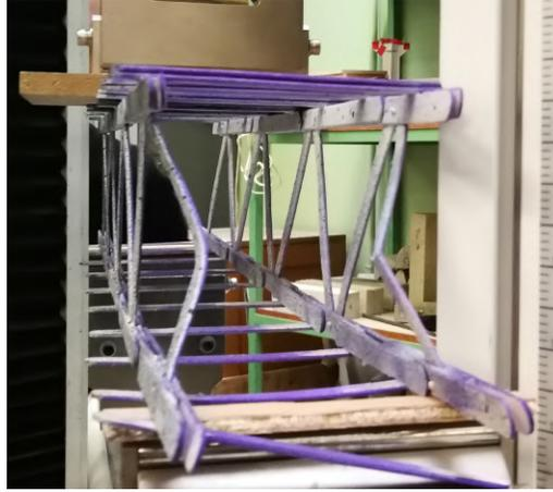
FIGURE 9 – Flambement sur l'essai à rupture de notre premier essai
