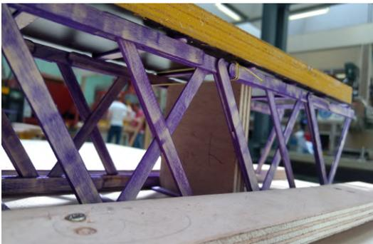
FIGURE 20 – Assemblage des deux treillis avec gabarits et ficelle
