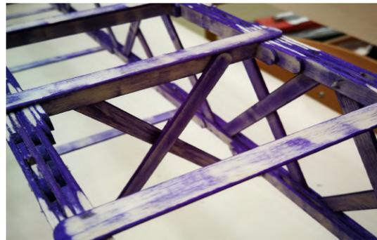
FIGURE 21 – Palée et poutre type IPN en haut du tablier final
