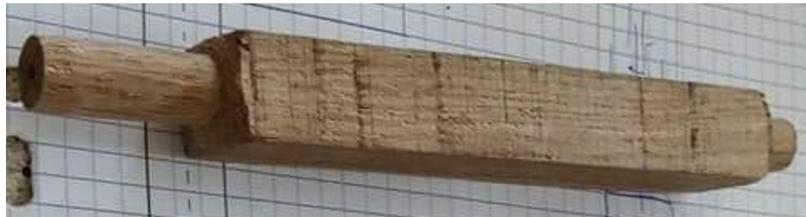
FIGURE 34 – Arbre en bois réalisé par opération de tournage
