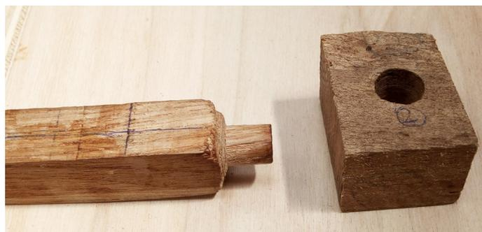
FIGURE 35 – Liaison pivot assurant le bon fonctionnement de la cinématique
