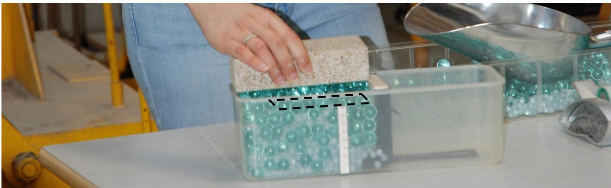
Figure 8 : Tirant en papier de verre est glissé dans une fente prévue dans le mur, il dépasse d'une douzaine de cm et est installé au milieu des billes
