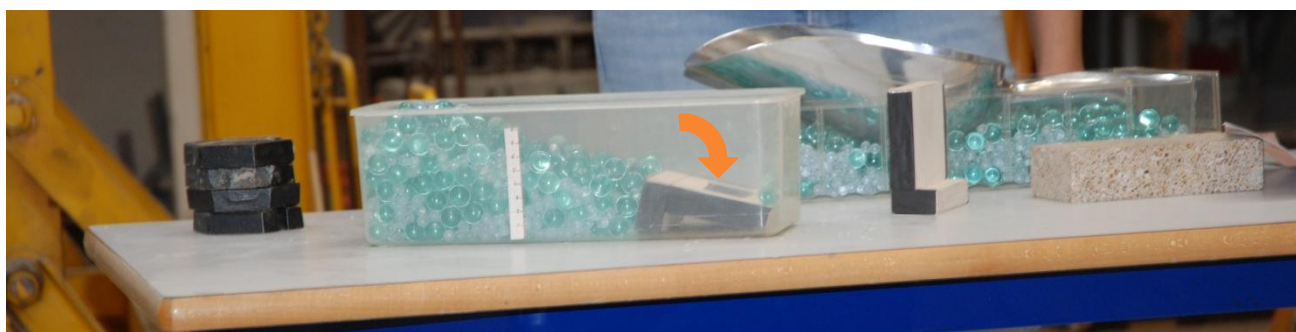
Figure 5 : Lorsque le mur n'est plus maintenu, le poids du sol fait basculer le mur
