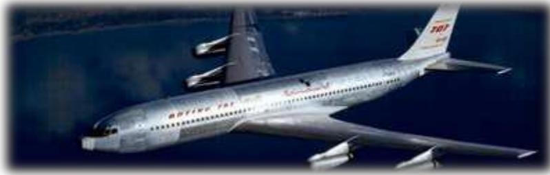
Cet avion va révolutionner le transport aérien et sera construit en 9000 exemplaires ! Sa forme est celle de quasiment tous les avions de transport de passagers depuis lors (ailes en flèche, réacteurs séparés et disposés sous la voilure).
