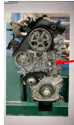
Le galet rouleau et la courroie se retire la pompe à eau se retirera aussi
