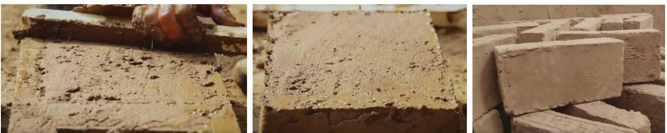
Figure 31 : Moulage, séchage et mise au four de briques, source [2]
