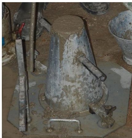
Figure 2 : Cône d'Abrams rempli, piqué et arasé
