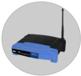
**D'un routeur Internet WIFI** : il est connecté au réseau **internet** et en distribue l'accès aux différents périphériques, notamment les postes clients du réseau lorsqu'ils en ont besoin. Il est relié par des câbles ou sans fil (par WIFI).
