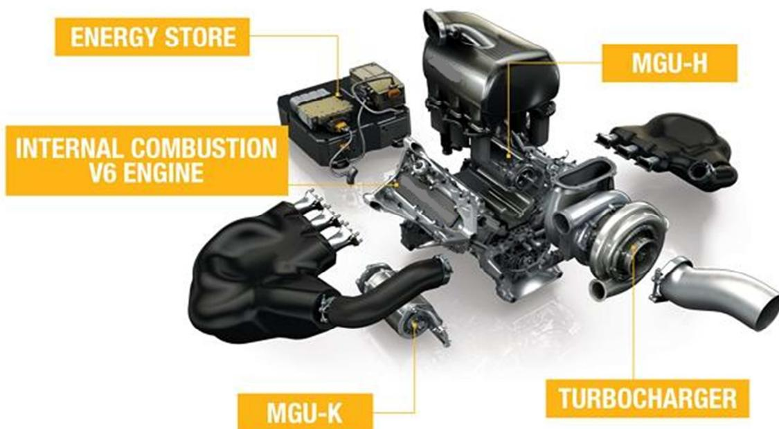
Une des particularités de ce règlement est de limiter le débit massique instantané de carburant à 100 kg/h à partir du régime de 10500 tr/min.
